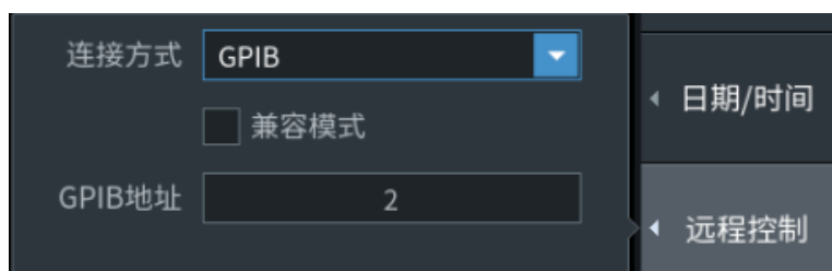
图 3.3 ZDL 示波记录仪远程控制 GPIB 界面
