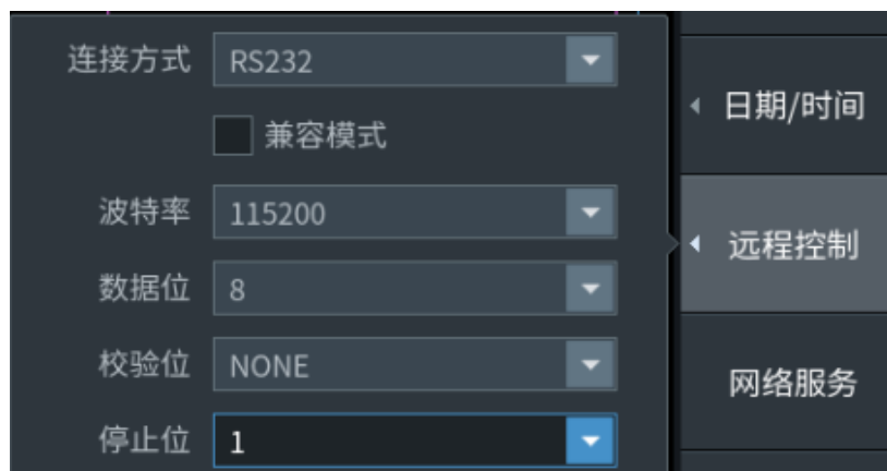
图 3.8 RS232 通信接口设置界面
