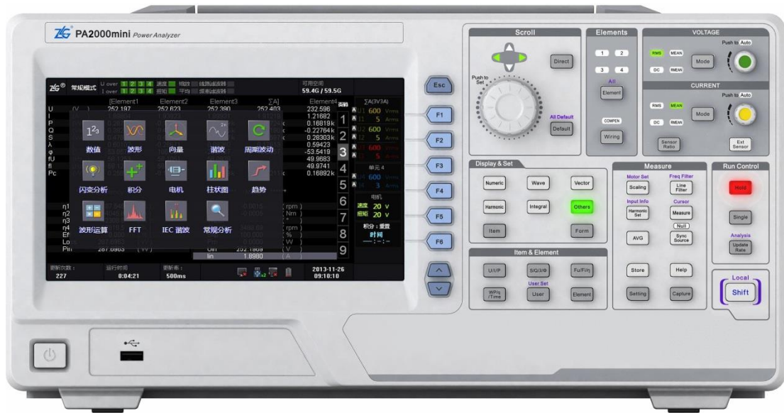
图 1.1 PA2000mini 高精度功率分析仪
