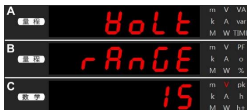
图 3.12 电压量程设置菜单
