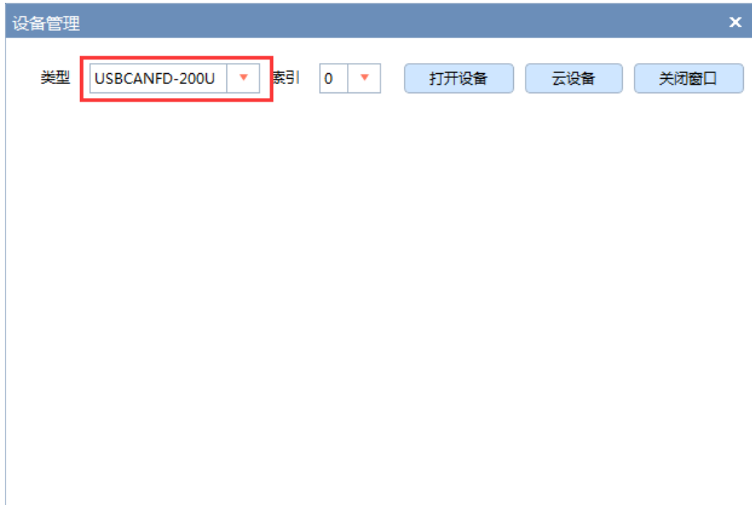
图 5.9 打开 ZCANPRO 选择设备 USBCANFD-200U
