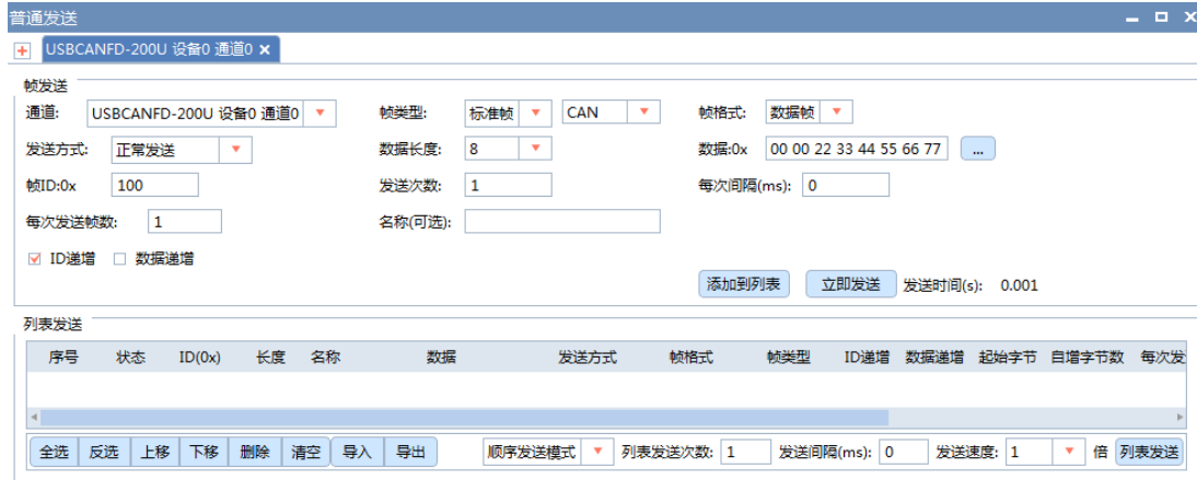
图 5.20 USBCANFD-200U 发送设置
