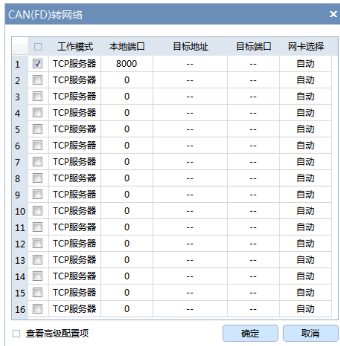
图 5.8 CAN(FD)转网络配置界面
