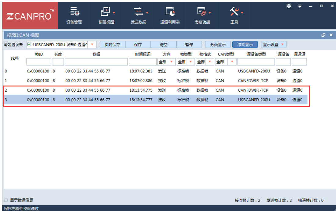
图 5.22 CANFDWIFI-TCP 发送结果
