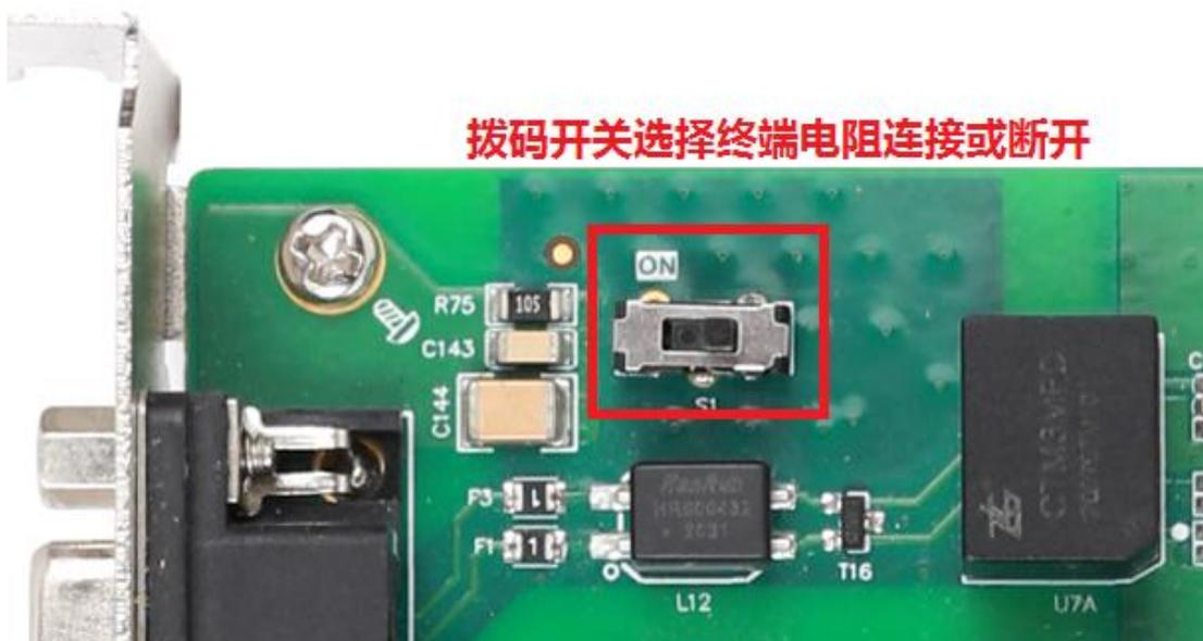
图 2.4 终端电阻选择开关示意图
