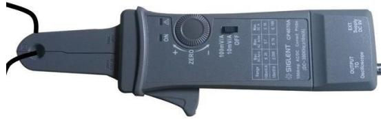
图2 连接 CP4070A 电流探头
