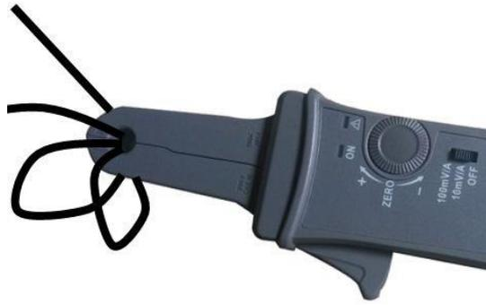
图4 提高电流灵敏度方式
